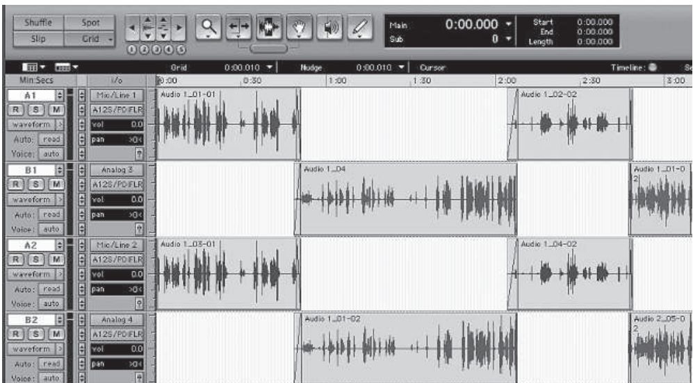
Paralelan prikaz audio-signalna (i njegovih tragova) sa pecaljke (A-1 i B-1) i sa ličnog mikrofona (A-2 i B-2).
